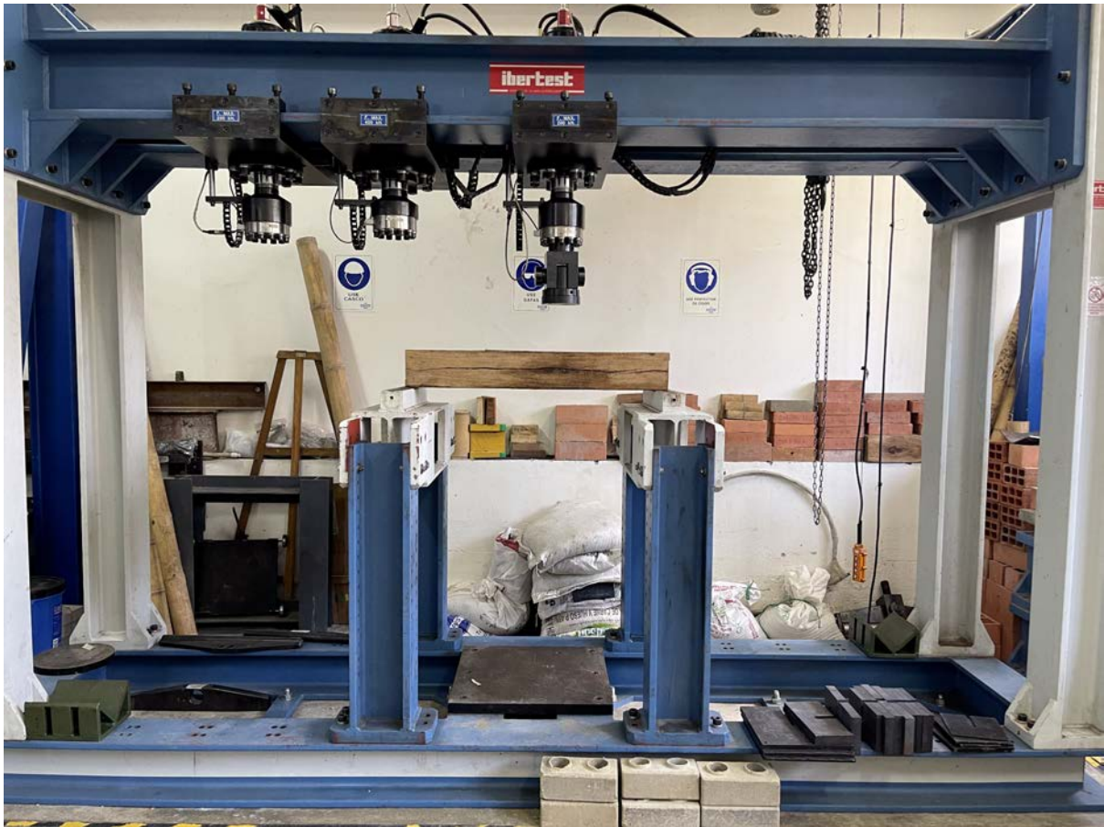
Figura 18. Pórtico universal de ensayos PFIB-DPC /400-200-200 /W.
