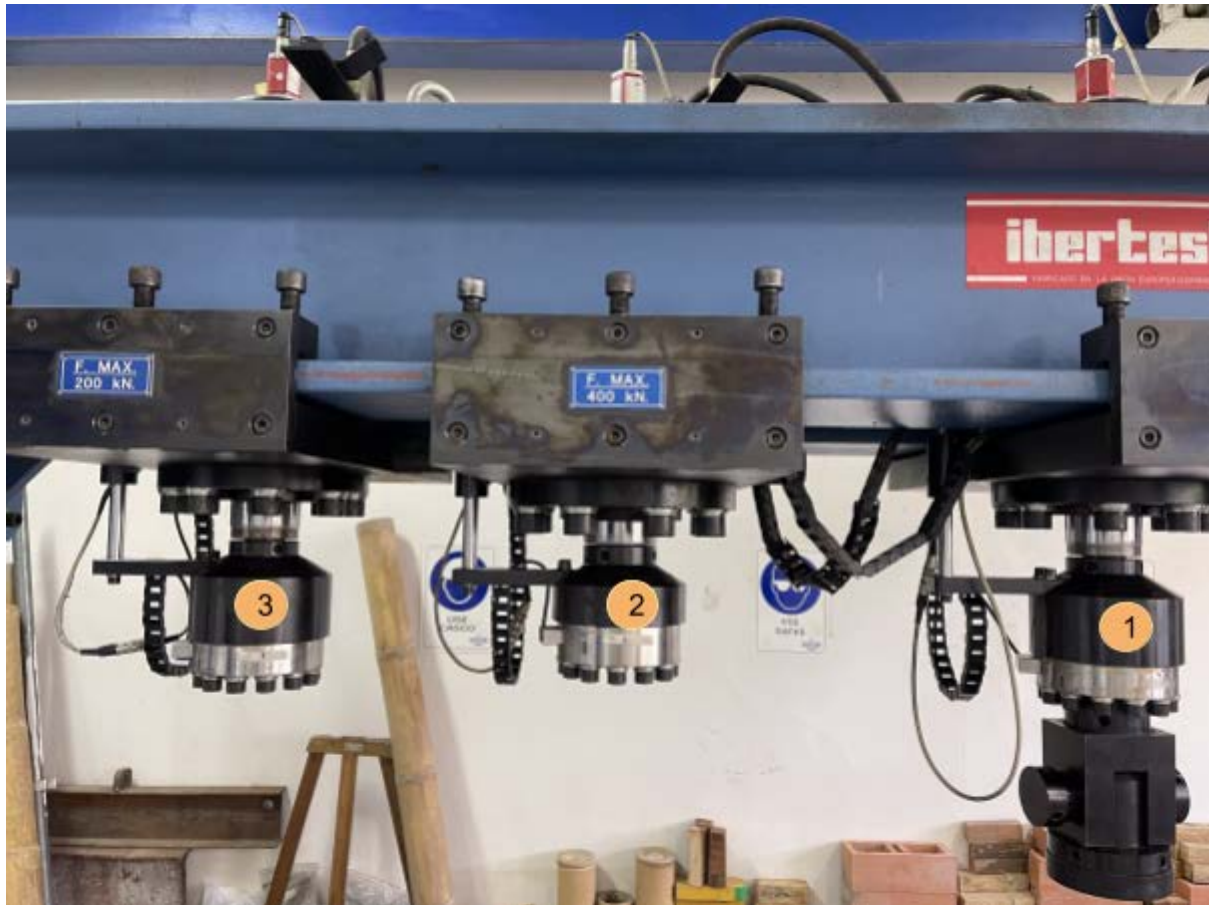
Figura 17. Disposición de cilindros hidráulicos en el pórtico de ensayos.
