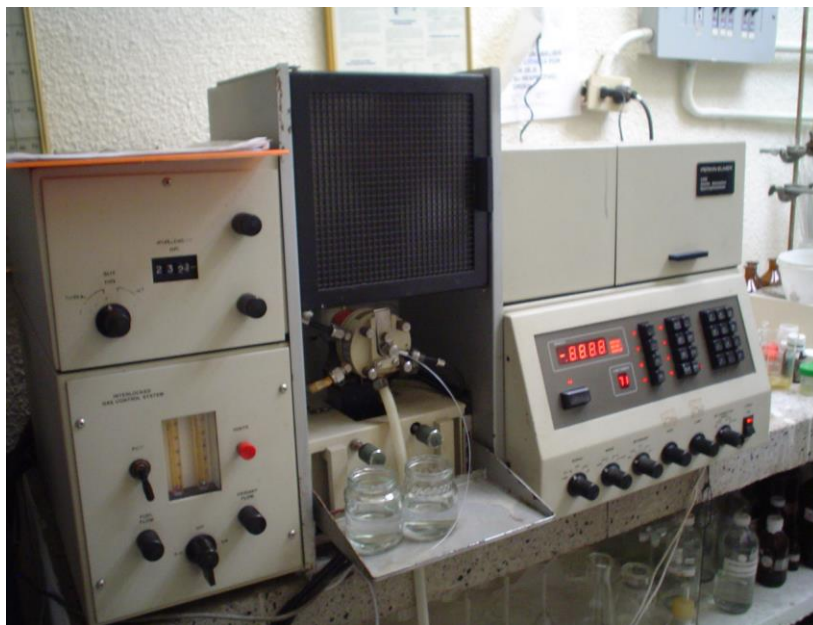
Espectrofotómetro de absorción atómica con llama, modelo 2380, marca Perkin Elmer. Con certificado de calibración.
