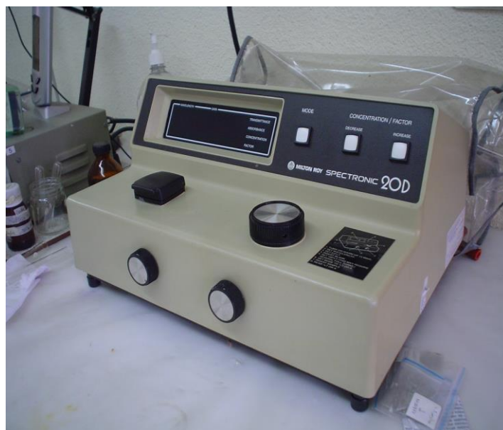
Espectrofotómetro Spectronic 20D, modelo 333175, marca Milton Roy. Con certificado de calibración.
