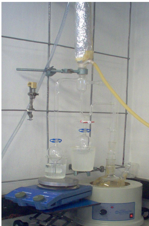
Figura 15: montaje DES para separación de la fracción volátil de tomate de árbol fresco, DO y DO-AC
