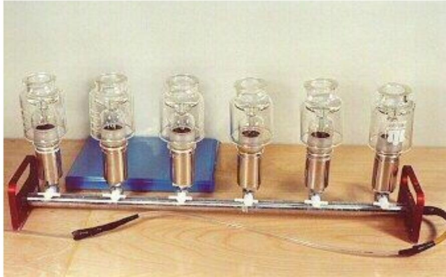
Figura 9 Sistema de extracción líquido – sólido de seis puestos.
