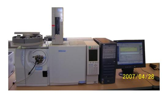
Figura 19. Cromatógrafo de gases
