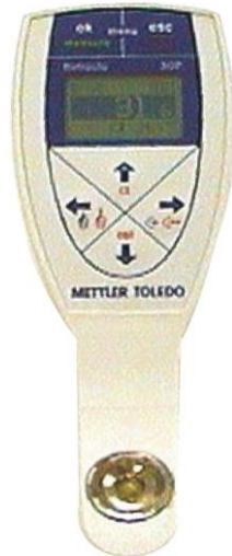
Figura 7: Refractómetro METTLER TOLEDO Refracto 30P, escala de 0 a 85 °Brix.
