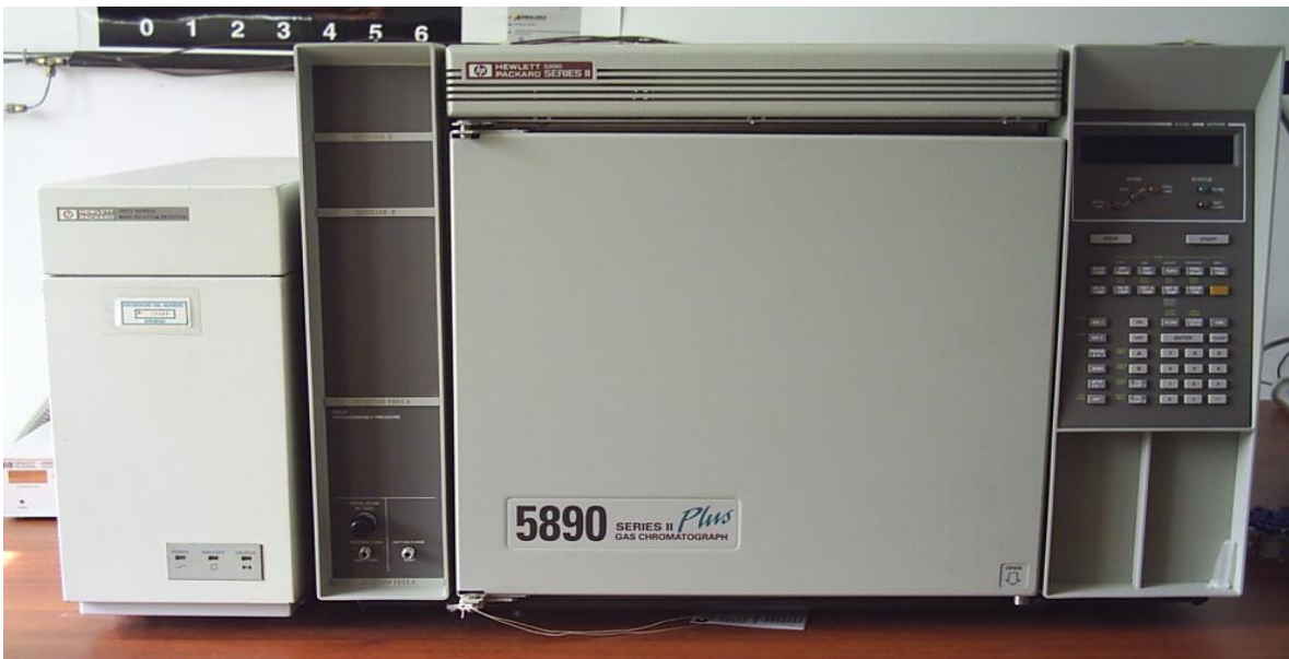
Figura 10 : Cromatógrafo de gases marca Hewleet packard 5890 serie II acoplado a un detector de masas,
