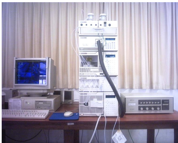
Figura 10 Cromatógrafo de líquidos de alta eficiencia (HPLC) marca Waters
