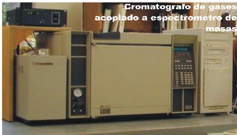
Figura 15. Cromatógrafo de gases acoplado a espectrómetro de masas.
