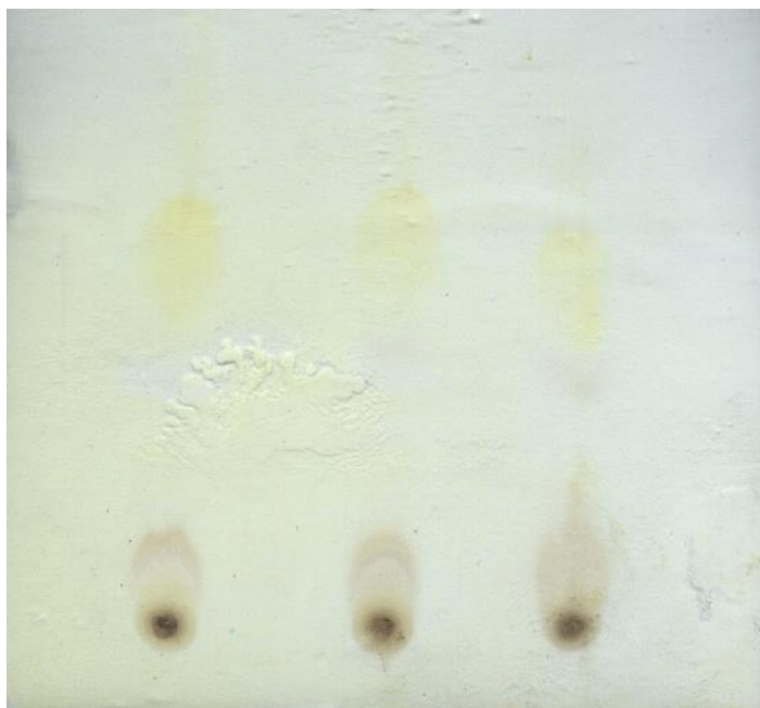
Figura N° 7. CCD del crudo alcaloidal con un Rf de 0.5 bajo el sistema eluyente de tolueno - acetato de etilo (93:7)
