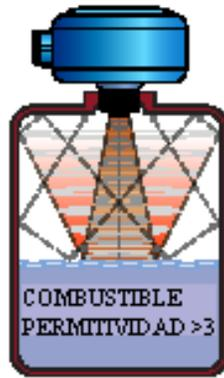
**FIGURA 7.9:** ubicación del sensor de nivel en el depósito
