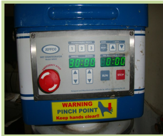
Figura 4. Jeffco (nuevo) desintegrador húmedo Modelo WDO2 serie No. A351 Motor 3.0 kW Corriente 6.1A Voltaje 440V Frecuencia 60Hz Velocidad del motor 3450rpm
