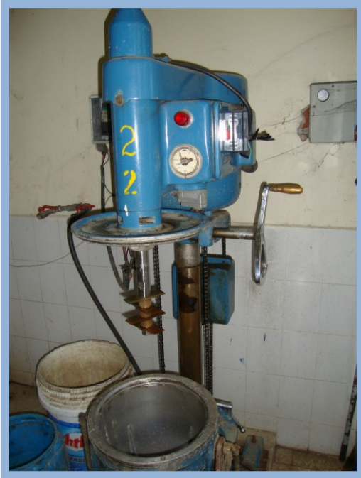
Figura 2. Jeffco (viejo) desintegrador humedo Modelo 292 serie No. A295 Motor 2.2 kW Corriente 8.1A Voltaje 220V Frecuencia 60Hz Velocidad del motor 3450rpm
