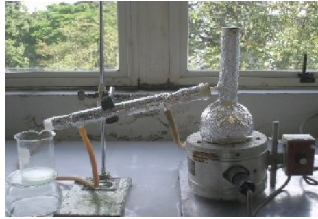
Figura 2. Equipo de Destilación por Arrastre con Vapor (DAV) utilizado para la extracción de aceite esencial
