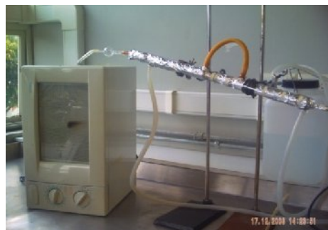
Figura 3. Equipo de Hidrodestilación Asistida por Microondas (MWHD) utilizado para la extracción de aceite esencial.
