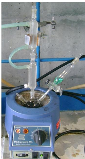
**Figura 56.** Montaje Síntesis del sistema Flavonoide-Cu
