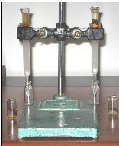
**Figura 13.** Columna de Cromatografía.
