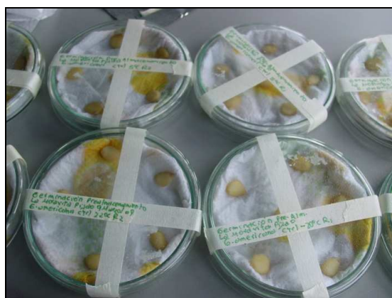
Figura 13. Prueba de germinación de semillas de G. americana en cajas petri y papel secante.
