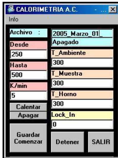
Figura 13. Interfaz De Usuario (IDU) del programa “Calorimetría 3.0” realizado en Visual Basic 6.0
