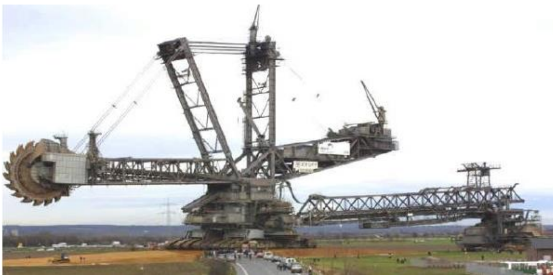
IMAGEN 5.17 Retroexcavadora de tambor
