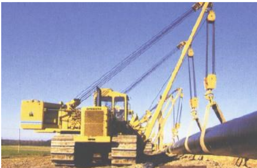
IMAGEN 5.33 Esquema cargador de tubos
