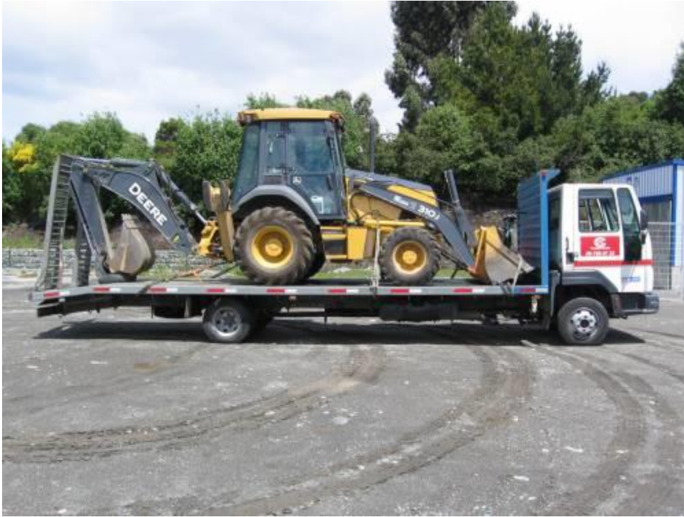
IMAGEN 5.15 Transporte retroexcavadora cargadora
