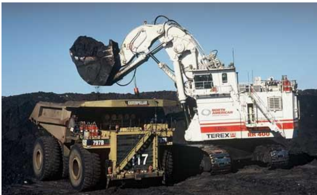
IMAGEN 5.27 Excavadora frontal cargando carbón
