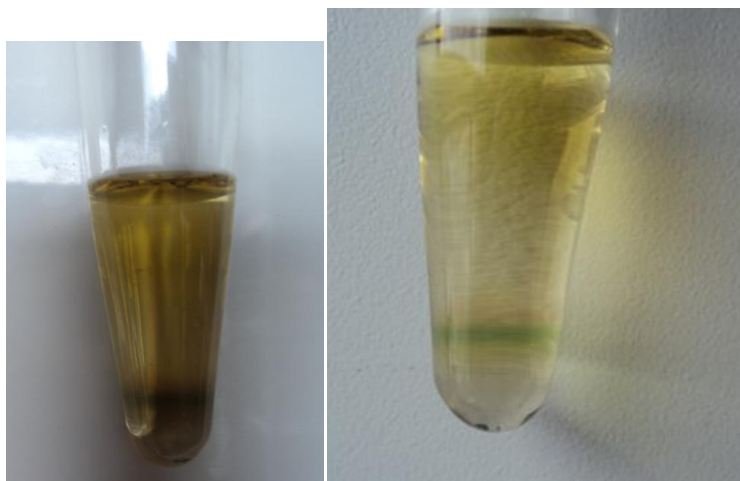
Figura 38. Resultados de la prueba Rosenthaler para la fracción I.d. E.ético. Col 1 positiva para sapogeninas esteroidales o triterpenoideas.
