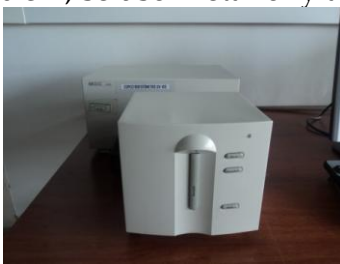
Figura 13. Equipo de Ultravioleta utilizado para identificación de metabolitos secundarios del extracto etanólico total de las hojas de Iresine Difussa Humb & Bonpl. Ex Willd.
